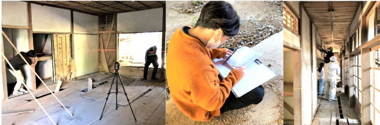
レーザー墨出器 (水平を示す赤い線)
