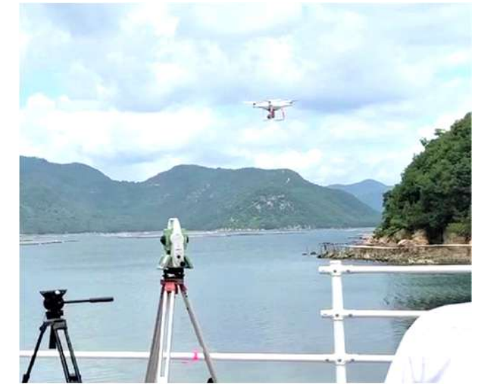
ドローンによる写真測量
