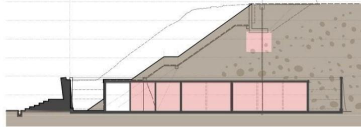
Step 3 : 第2段階法面盛土掘削、擁壁施工、階段撤去・妻側壁面変形是正
