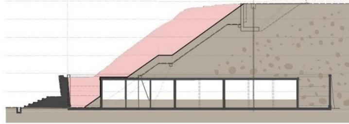
Step 2 : 内部空隙充填・一部地盤改良
