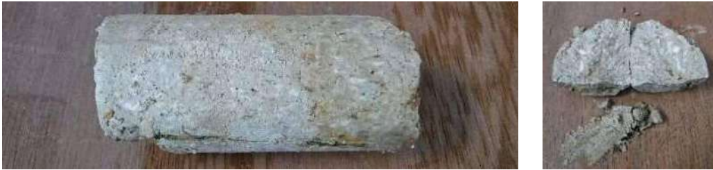
風化岩（WGr）の試料状態
